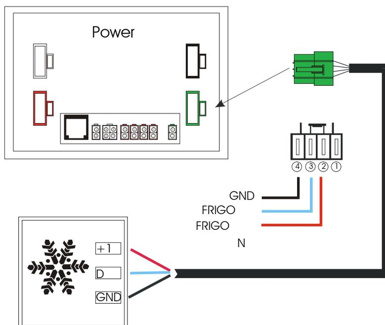
Figure 3 “Branchement Alimentateur – Réfrigérateur Standard”
