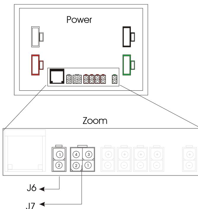
Figure 5 "Câblage Alimentateur – Capteurs de niveau"
