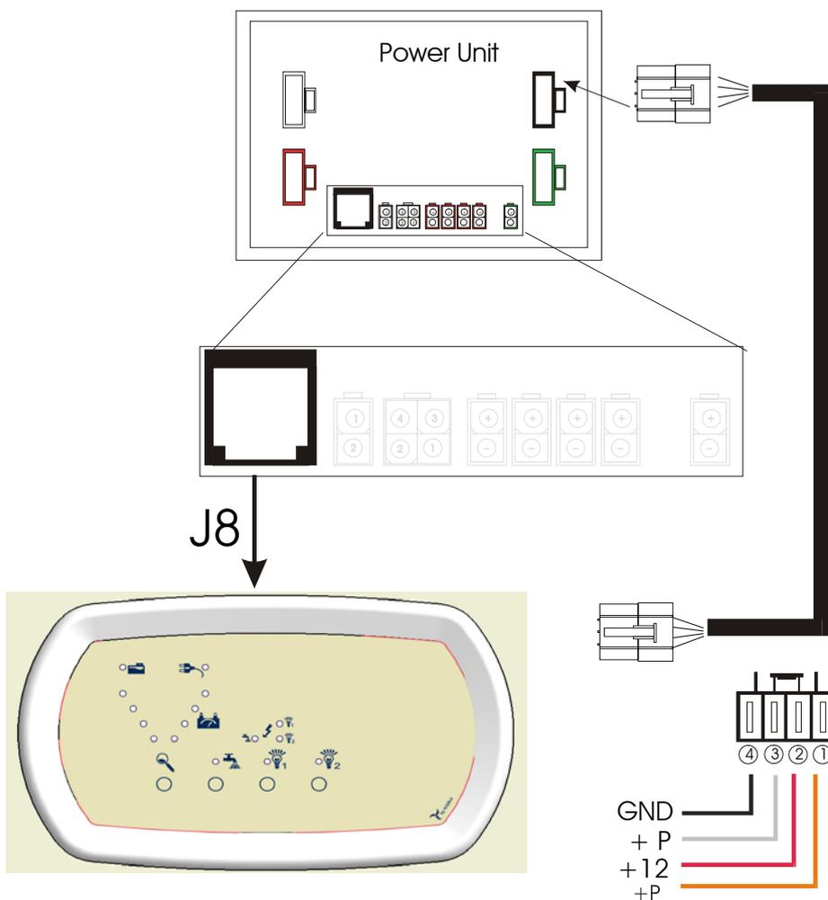
Figure 6 “Câblage Alimentateur - Centrale”
